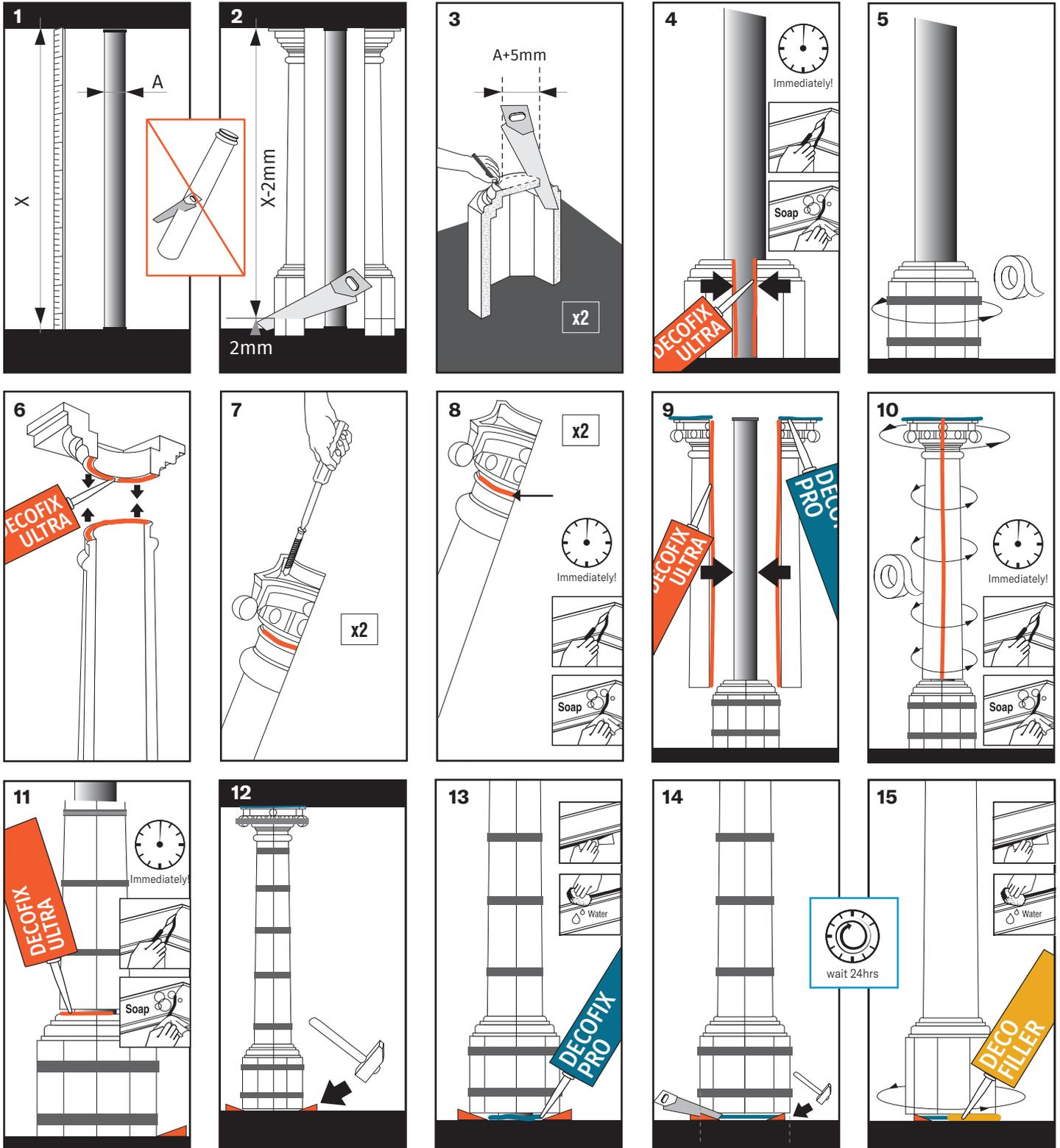
**Removal excess adhesive** | Verwijderen overtollige lijm | Éliminez les excès de colle | Überschüssigen Kleber entfernen | Eliminar el exceso de adhesivo | Rimuovere la colla in eccesso | Usuwanie nadmiaru kleju
